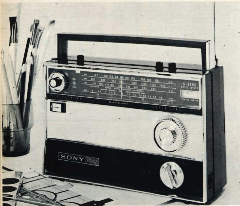
Fig. 1 - Ricevitore portatile SONY TFM — 1500 L — per onde lunghe, medie, corte e VHF (FM). Antenna per onde lunghe e medie in ferrite, per onde corte e VHF telescopica. Presa per antenna esterna.
