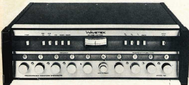
Fig. 2 - Sintetizzatore programmabile WAVETEK (Ing. M. Vianello), mod. 157 generatore di onde sinusoidali, triangolari e quadre.
