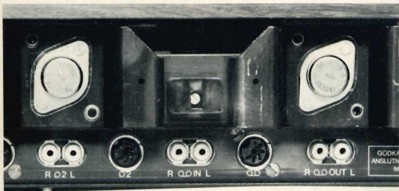
Fig. 1 - Ogni presa di ingresso è doppia: una presa a cinque terminali corrisponde allo standard europeo, due prese RCA permettono il collegamento di tutti gli apparecchi di origine anglosassone.
