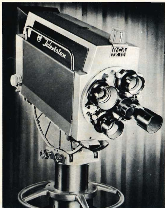
Fig. 3 - lens turret; torretta porta obbiettivi; tourelle à lentilles, torre de lentes; Objektivrevolver.
