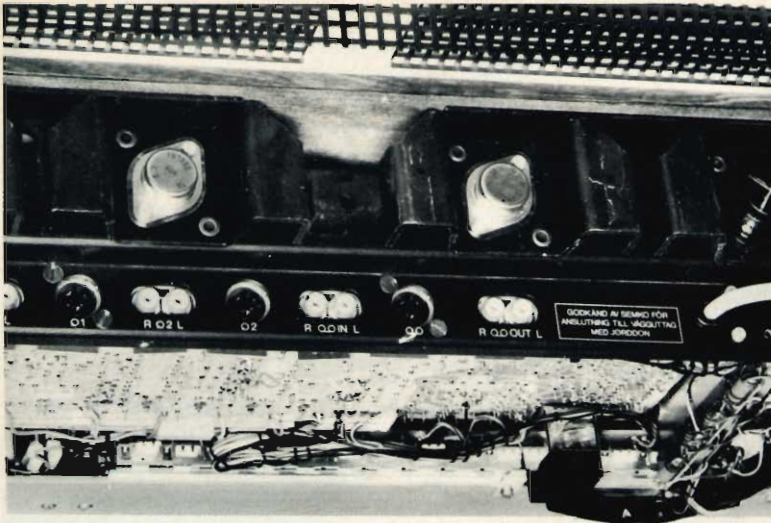
Fig. 6 - I transistori di uscita sono montati su radiatori sufficientemente grandi che permettono la dissipazione del calore. Una griglia protegge tali transistori da eventuali corto-circuiti accidentali. La griglia si può vedere nella figura stessa.
