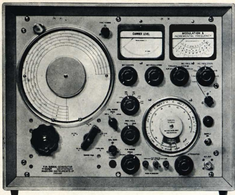
Fig. 2 - Generatore di segnali di tipo professionale Marconi TF 1066 B/6 da 10 a 470 MHz per AM e FM con deviazione di frequenza da 0 a 100 kHz.
